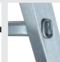
4-fach gebördelte Sprossen-/ Holmverbindung
