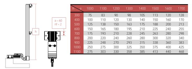
Befestigung auf der innenseitig gedämmten Attika-Oberseite mit Barrial Fuß Z ite, Zr ite
